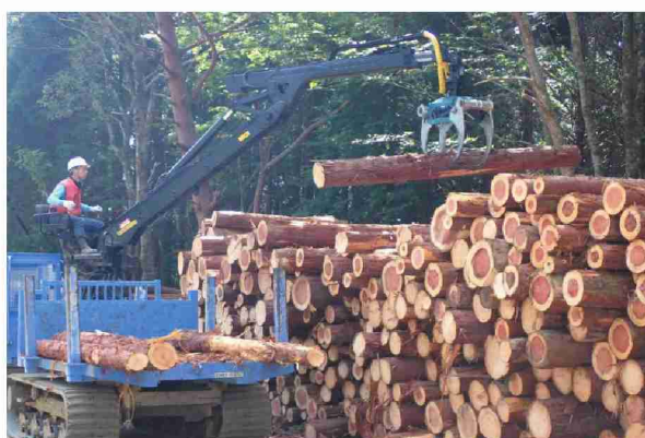
フォワーダによる山土場での作業(R5年10月撮影)
