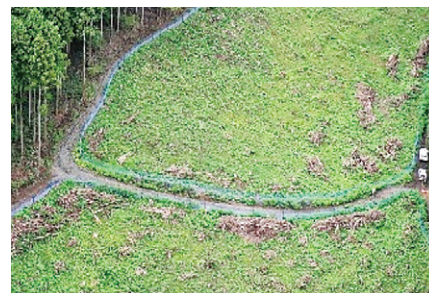
図3：ブロックディフェンス方式で設置した防護柵
