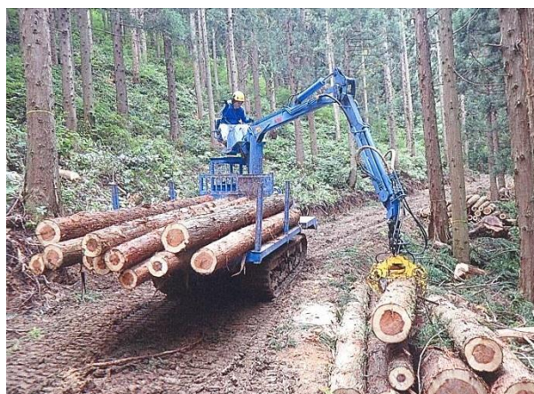
間伐木の集材状況 (山形県東根市)
