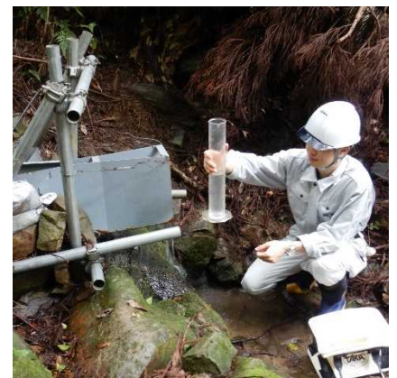
沢城地区試験地での 流量・水位データ収集の様子
