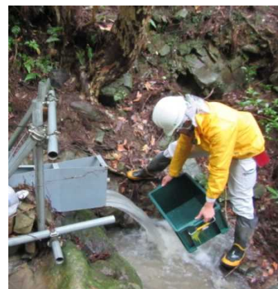
沢城地区試験地での 流量・水位データ収集の様子
