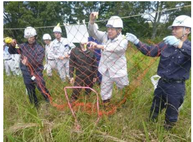
補修パッチを用いた生物害防除についての現地検討 (九州整備局)
