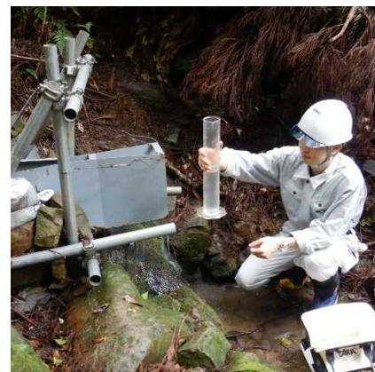
沢城地区試験地での 流量・水位データ収集の様子
