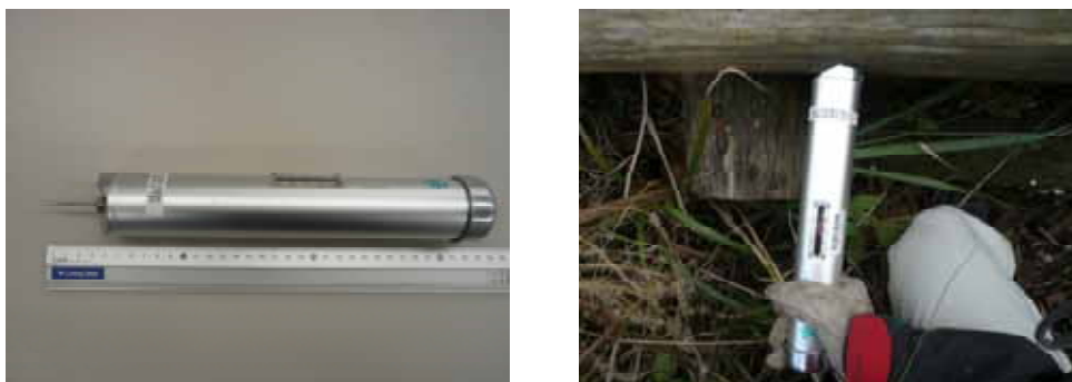
図-1 ピロディンと測定の様子
