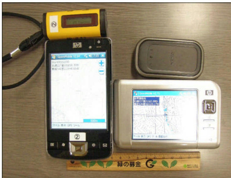
図 1-3 上がGPS レシーバ、下がPDA。 事務所ではこの2種類を使用しています
