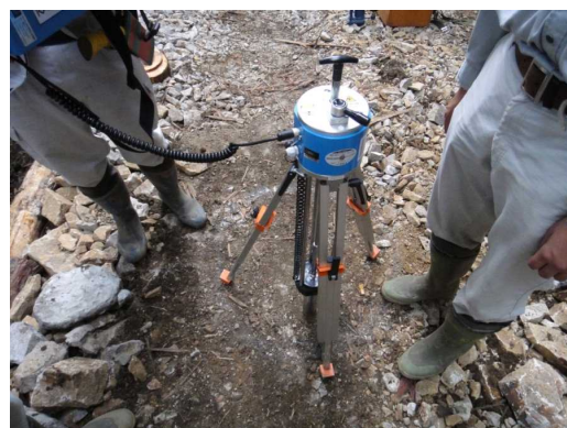
写真－12 簡易支持力測定器による調査状況
