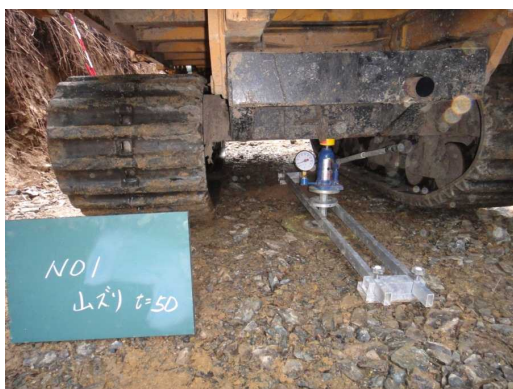
写真－11 一点載荷試験装置による調査状況
