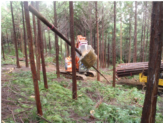
写真11、12 高性能林業機械による作業道への搬出作業
