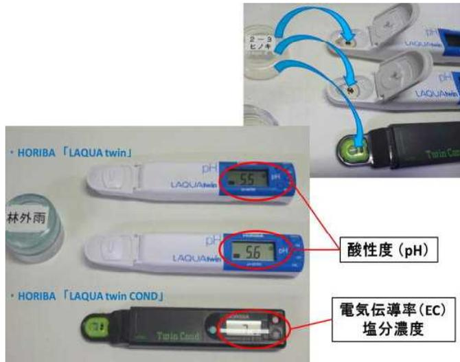
写真－５ 酸性度・電気伝導率の測定
